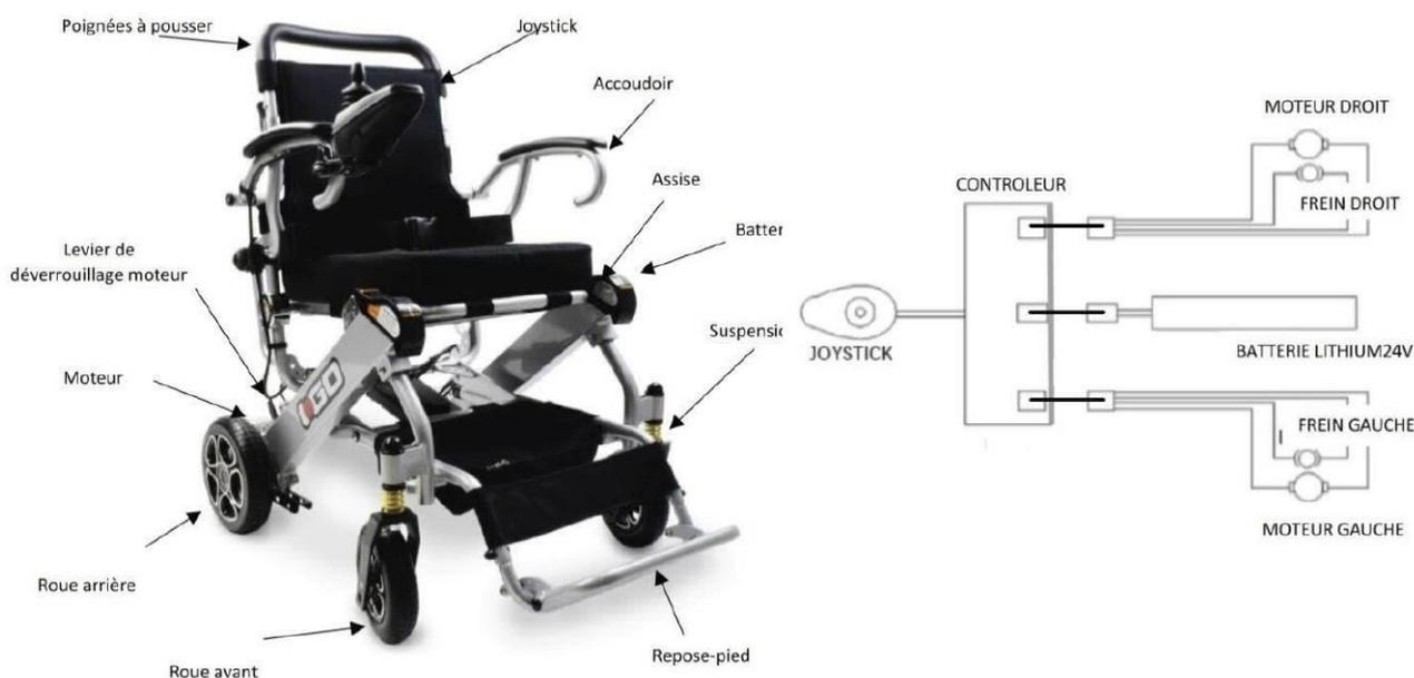
Le fauteuil roulant électrique est basé sur une version manuelle à laquelle il a été rajouté les éléments suivants :
